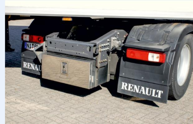
▲ Der Einbau der Ladesicherungsgut-Staubox am Renault Magnum „990“ war besonders aufwendig. Alle Fahrzeuge führen das Sicherungsmaterial an der Zugmaschine mit.
